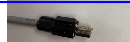
SPE規格 IEC63171-6 JAE様 DZ17コネクタ 1-Pair UTP 100BASE-T1
